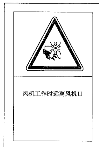
图 B.3 风机口安全 标志示例
